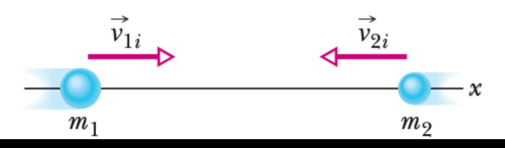
$$m_1(v_{1,i} - v_{1,f}) = -m_2(v_{2,i} - v_{2,f})$$
